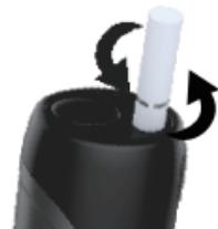
更换烟弹方式2：侧面滑动取烟键，烟杯和烟支会同时升起，取出烟杯，拔出旧烟弹，然后把烟杯装回原位，换上新烟弹即可。
